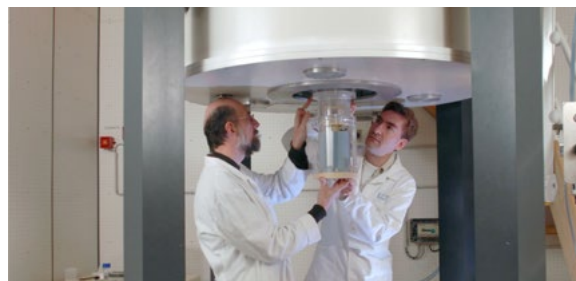
Imageur par résonance magnétique dédié aux matériaux du génie civil et de l'environnement (laboratoire Navier à Marne-la-Vallée)
