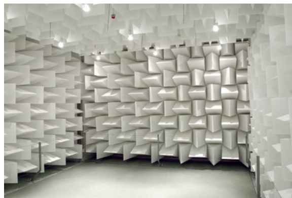
Salle semi-anechoïque de l'Ifsttar à Nantes / Bouguenais : enceinte isolée dont les murs et le plafond sont capitonnés pour absorber l'énergie acoustique incidente © Hugues Delahousse / IFSTTAR
