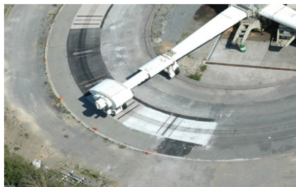
Manège de fatigue (accélérateur de trafic) des structures des chaussées (Nantes / Bouguenais) © IFSTTAR
