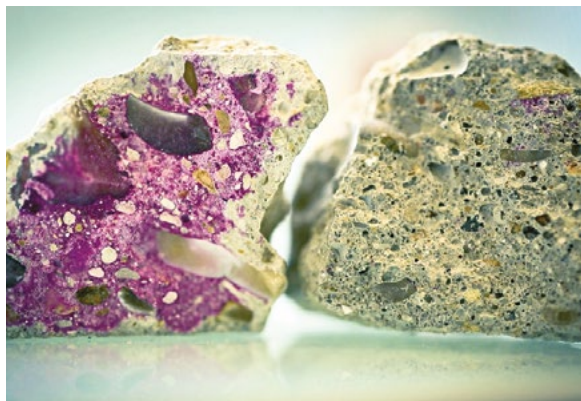
Visualisation de la carbonatation des granulats recyclés par un indicateur pH coloré, comparaison entre granulats carbonatés naturellement (à gauche) et granulats carbonatés de manière accélérée (à droite)
